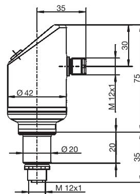
Тип 902940/50 с цилиндрич. подключением M12 x 1 для резистивного термометра
